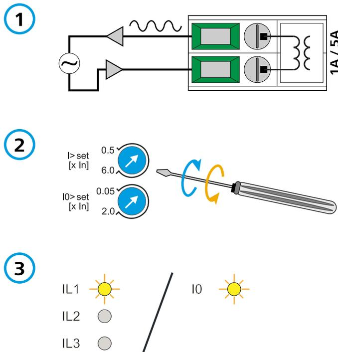
1. Den gewünschten Wert des aktuellen Anzugspegels getrennt auf IL1 und auf IO einspeisen (IO> nur bei AQ-110P).
