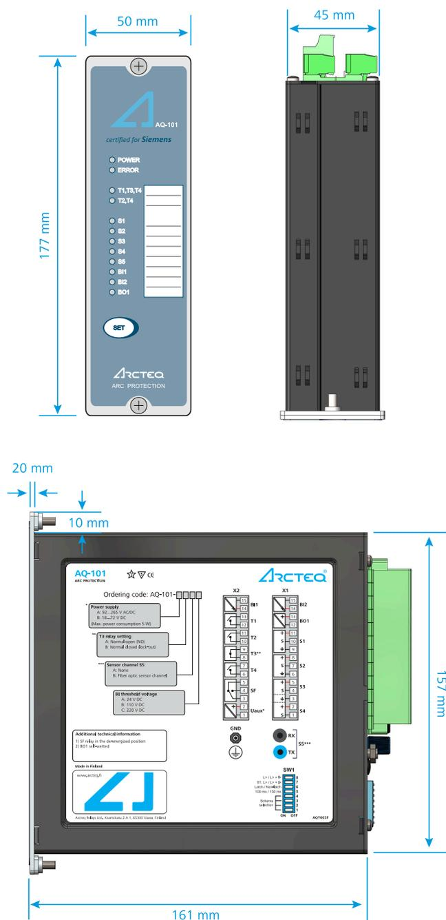
Abbildung. 12.1 - 37. Abmessungen des AQ-101 Schalttafelabschnitts.
