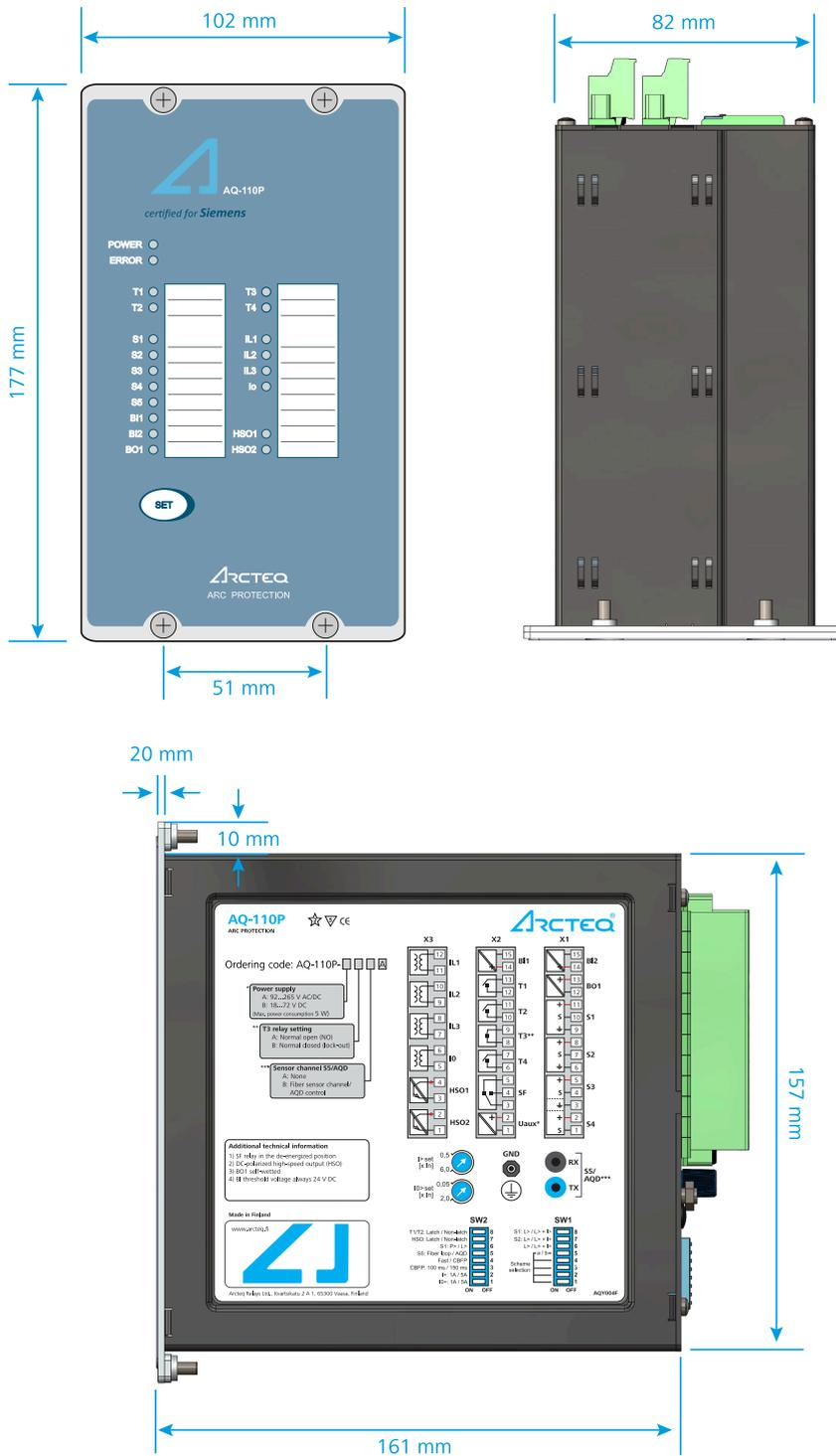
Abbildung. 12.1 - 40. Abmessungen des AQ-110P Schalttafelausschnitts.
