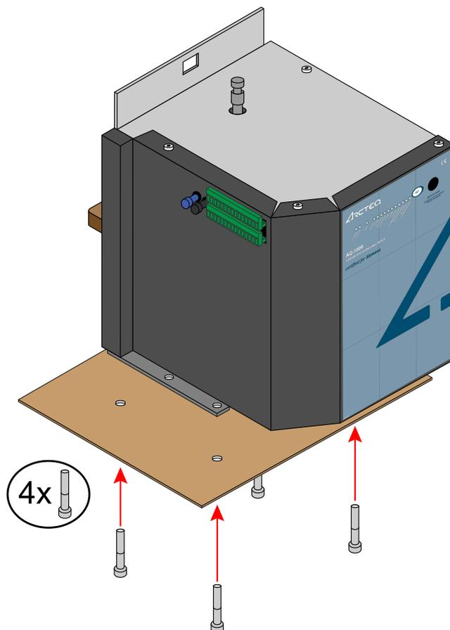
Abbildung. 4.1.3 - 4. Installation von AQ-1000 (Möglichkeiten für Sammelschienenmontage).
