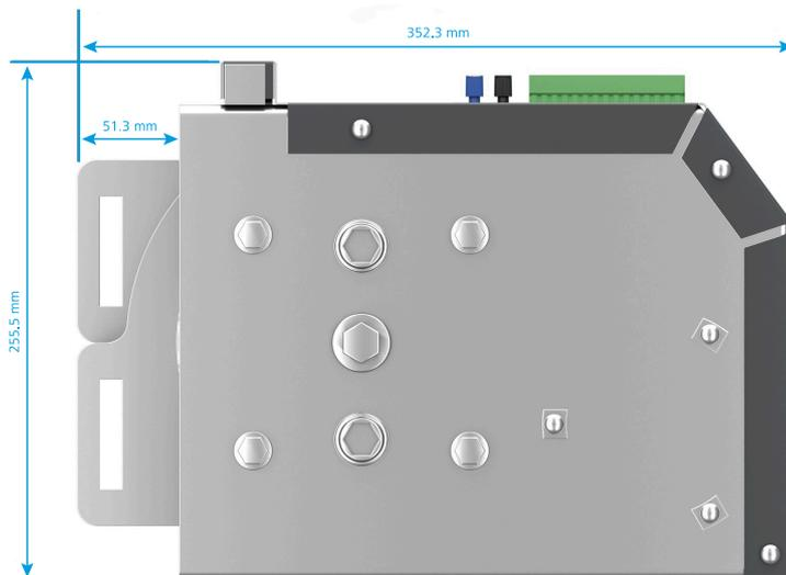
Abbildung. 12.2 - 43. Abmessungen des AQ-1000 (bei Betrachtung des Geräts von der Rückseite).
