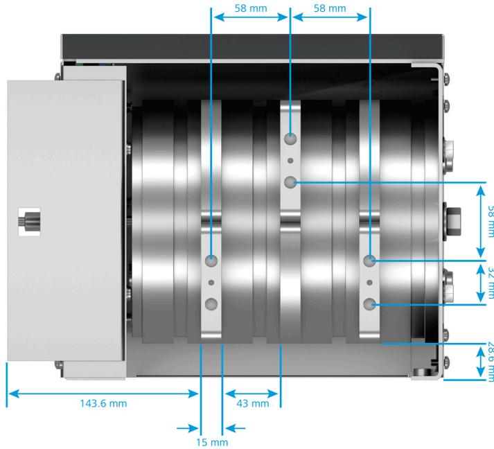
Abbildung. 12.2 - 44. Abmessungen des AQ-1000 (bei Betrachtung des Geräts von unten).
